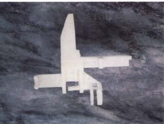
Foto 2 a, b, c, d - La tecnica di prototipazione rapida della Stratasys può creare in poche ore modelli tridimensionali in qualsiasi geometria e forma, complessità e materiale.
